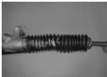
②サイドシールのブーツの切れ目からオイルが漏れ出している。
