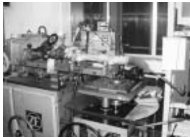
⑤専用のテストベンチで油圧などの数値を計測して品質検査。
