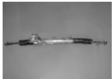
①8万kmの走行をこなしたラック&ピニオン式ステアリングギア。
