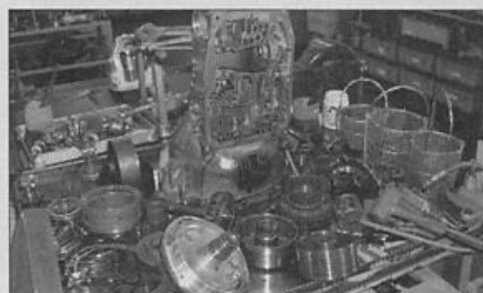
工場に持ち込まれ、完全にバラバラにされたミッション。技術者が全ての部品をチェック、不良部品があれば交換する
