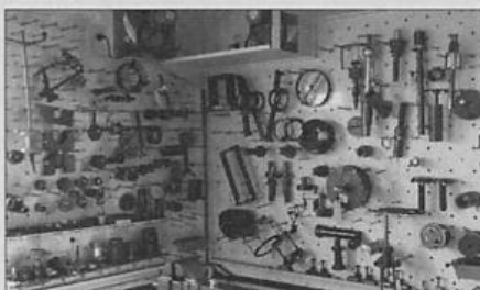
フルオーバーホールをする際に必要な数え切れない程の専用工具。ひとつでも欠けると分解・組み立てが出来ない。
