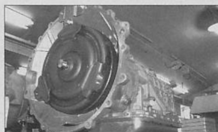
リビルトATミッションの完成品。あれだけバラバラになっていたミッションが見事に再生され、出荷を待っている。
